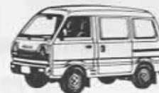
**3. Clevere Transporter: Carry.** 27 kW (37 PS), 4 Zyl., Hubraum 791 cm<sup>3</sup>. Abmessungen: Länge 3195 mm, Breite 1395 mm, Höhe 1650 mm (als Hochdach 1855 mm).
